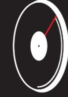
**Samples auswählen.** Drehe den Plattenteller, bis angezeigte Samples an die rote Markierung wandern. Halte den Teller kurze Zeit still, um das entsprechende Segment zu selektieren.
